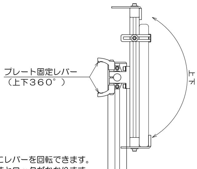
※レバーを引き上げるとロックが外れ、ねじを緩めずにレバーを回転できます。レバー同士が干渉しない位置まで回し、レバーを離すとロックがかかります。
