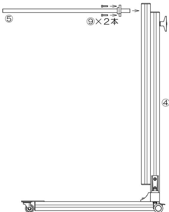
左図のように(2)で組立てたフレームに⑤丸シャフトを取付けます。④スライド支柱の丸穴に⑤丸シャフトを挿し込み、⑨六角穴付ボルト2本で締結して下さい。
