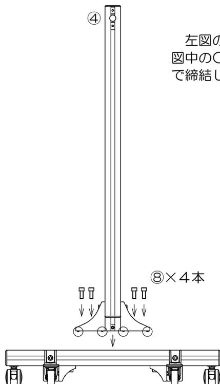
左図のように(1)で組立てたフレームに④スライド支柱を取付けます。図中の○印の突起を相手側のフレームの溝にはめて、⑧六角穴付ボルト4本で締結して下さい。
