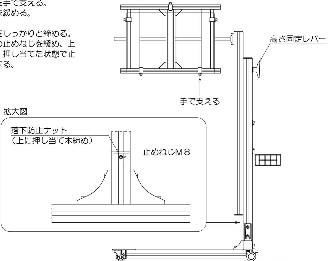
※落下防止ナットは、万が一高さ固定レバーが緩んでしまった場合に、スライド支柱の落下を防ぐとても重要な部品です。確実に固定して下さい。
